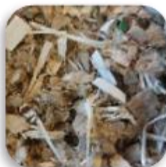
Le broyat de cagettes avec des panneaux de fibres : granulométrie de 20 mm
